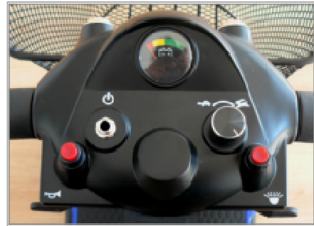
CUADRO DE MANDO Regulador velocidad Luces LED – Claxon Indicador carga batería
